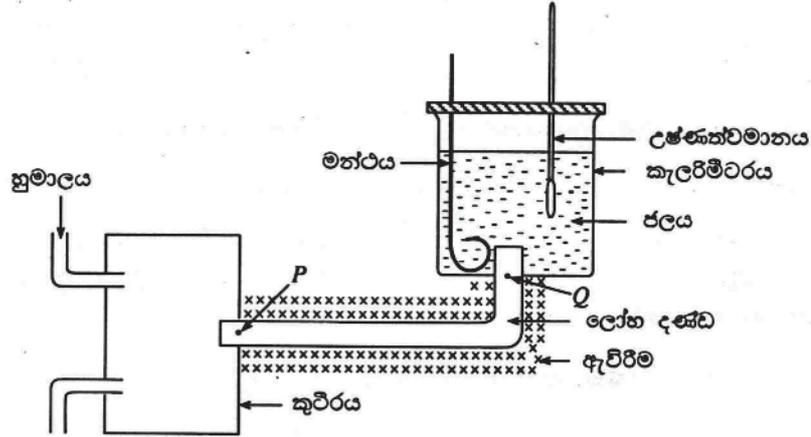
ඒකාකාර හරස්කඩක් සහිත දණ්ඩක ආකාරයෙන් පවතින ලෝහයක තාප සන්නායකතාව නිර්ණය කිරීම සඳහා රූපයේ පෙන්වා ඇති ඇටවූම භාවිත කළ හැකි ය. මෙම පරීක්ෂණයේ දී කුටීරය හරහා  $100\text{ }^\circ\text{C}$  හි හුමාලය යවන අතර කැලරිමීටරයේ ඇති ජලයේ උෂ්ණත්වය  $\theta$ , කාලය ,  $t$  සමඟ මනිනු ලැබේ.
